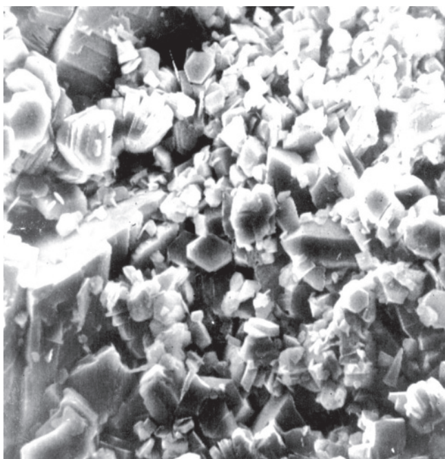
Рис. 6. Поры растворения и выщелачивания в доломите, выполненные новообразованным кристаллическим нанокаолинитом (гексагональные таблочки), D 2 (Новосибирская область, Малоичская скв. 2, инт. 2848,6–2848,2 м, РЭМ)
