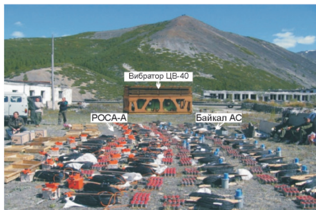
Рис. 1. Пример системы наблюдений (а), виброисточника и регистрирующей аппаратуры (б) для глубинных вибросейсмических исследований на востоке России
