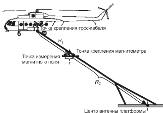
Рис. 4. Определение координат магнитометра по измеряемым координатам точки крепления трос-кабеля и центра платформы
