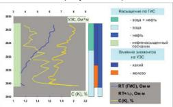
В стандартной интерпретации материалов ГИС низкоомный УВ насыщенный интервал трактуется как водонасыщенный, вследствие чего пласт не перфорируется.
