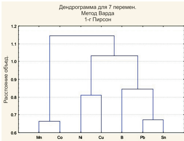
Рис. 3. Результаты кластерного анализа проб по вторичным ореолам рассеяния
