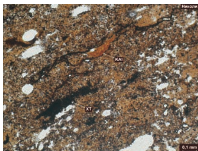
Рис. 11. Линзы коричневого KA1 с комковатой структурой и темно-коричневого XT с мелкоячеистой структурой в умеренно обогащенном ОВ ( C_{\text{орг}} 3,49 %) органогенно-детритовом доломитовом силиците. Центральная фациальная зона, Кюленкинский разрез
