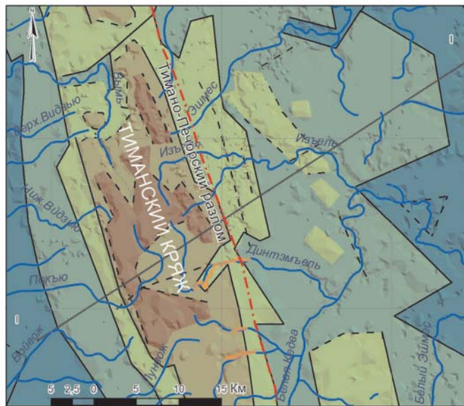
Рис. 18. Схема дешифрирования цифровой модели радарного космического снимка «АСТЕР» v2 методом усреднения с шагом по высоте 50 м
