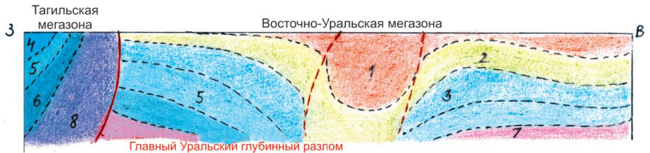
Рис. 7. Модельный глубинный поперечный разрез в районе Салдинского плутона (Средний Урал)
