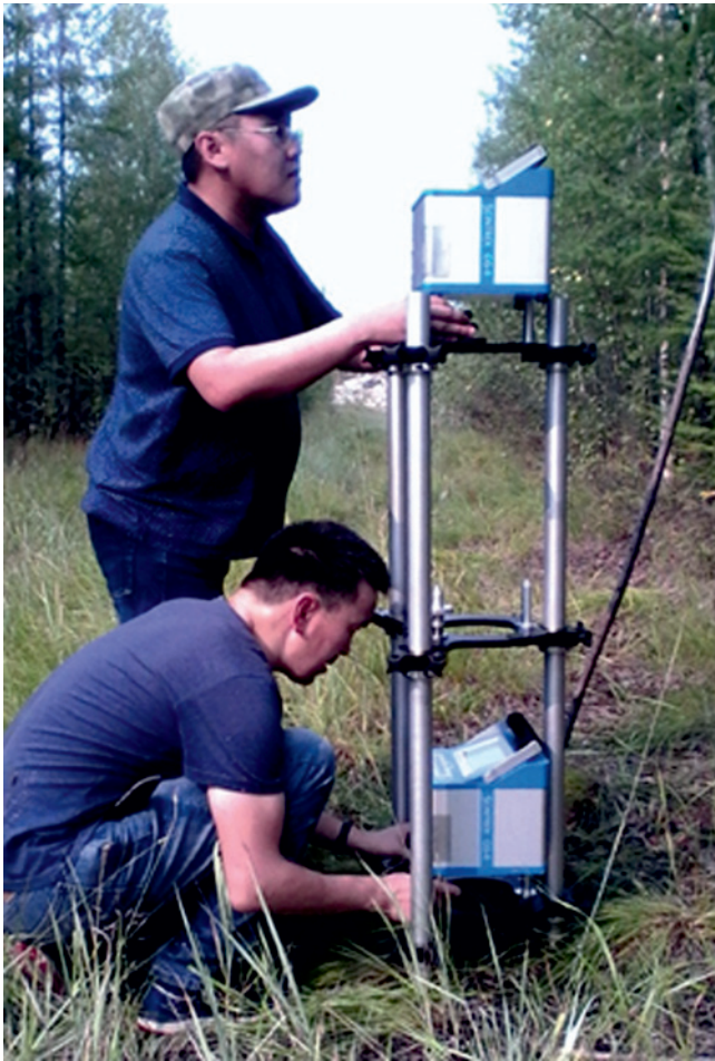
Рис. 1. Установка двух гравиметров CG-6 на площадках штатива TRIDENT
