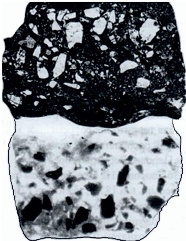
**Рис. 4.** Рудная жила массивной текстуры обломочной разнозернистой структуры. Фото обр. Л-21 (вверху) и радиография в течение 10 ч (внизу). Место отбора образца см. на рис. 3
